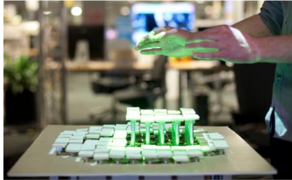
Abb. 2.3.: Mit 2,5-dimensionalen Shape Displays wird eine direkte haptische Interaktion ermöglicht. [Lei+48]
