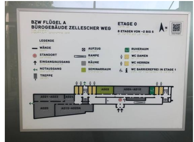
Abb. 4.5.: Taktile Gebäudeplan des Bürogebäudes Zellescher Weg der Technischen Universität Dresden, Deutschland Material: Hartplastik
