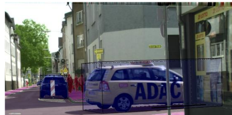
Abb. 3.1.: 3D Bounding Box Annotation in einem RGB-Bild [Gäh+20]. Daraus kann eine räumliche Einordnung des Objektes erstellt werden.
